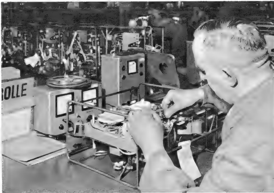
Kontrollplatz für die Lauffunktionen der Geräte
